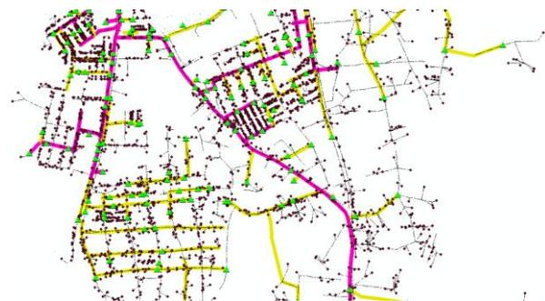
En la Tabla 1, se detallan las características del alimentador, en relación a los kilómetros de líneas de media y baja tensión y la cantidad de transformadores para el servicio de 6275 usuarios de baja tensión, destacándose por la capacidad de abastecimiento y alcance. Estos datos reflejan la magnitud y la
