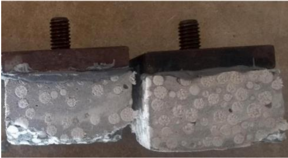
Figura 1. Vista transversal de muestra de las perlas de poliestireno expandido (EPS)
