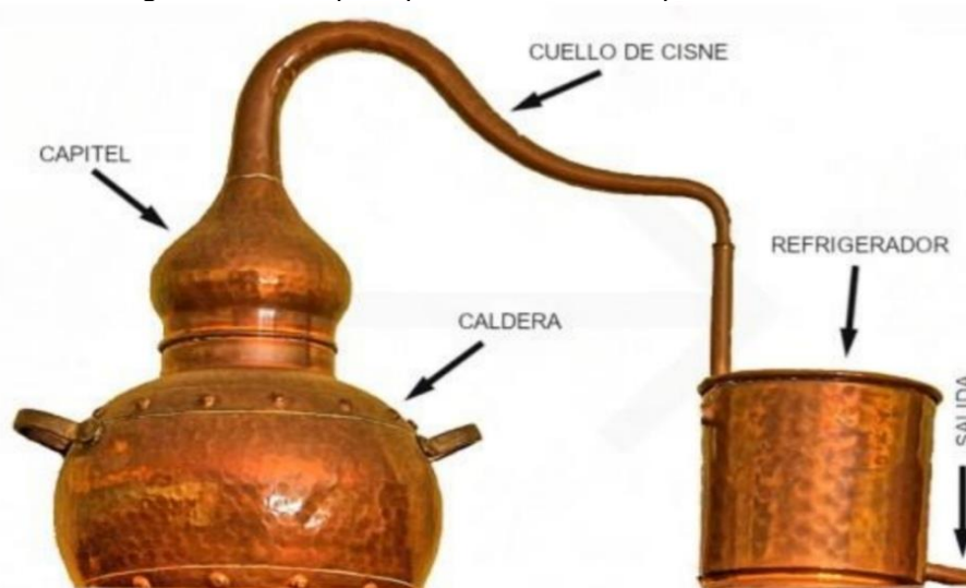
Figura 5. Partes principales de un Alambique convencional
