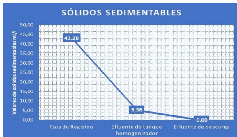
Figura 10. Comportamiento promedio del Sistema Wetland con respecto al parámetro de sólidos sedimentables
