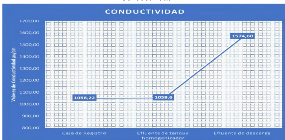
Figura 4. Comportamiento promedio del Sistema Wetland con respecto al parámetro de Conductividad
