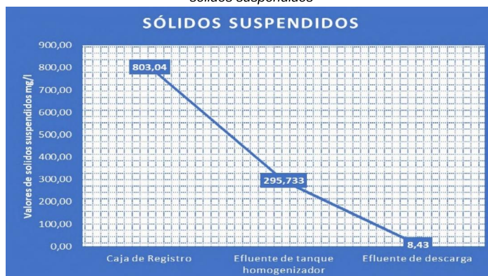
Figura 12. Comportamiento promedio del Sistema Wetland con respecto al parámetro de solidos suspendidos
