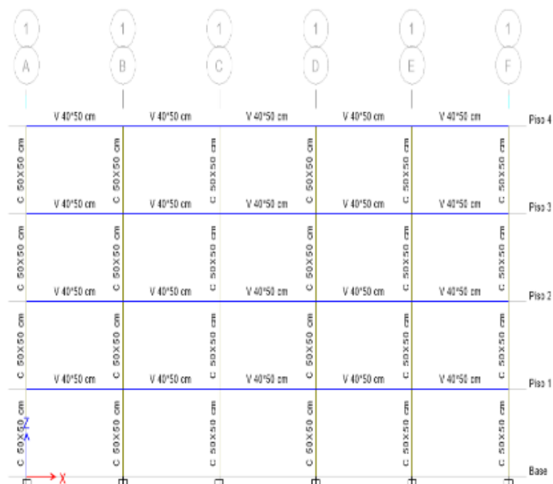
Figura 3. Vista en Elevación del edificio de análisis
