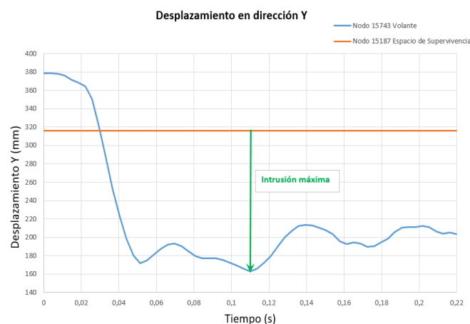
Figura 10. Desplazamiento del volante respecto al espacio de supervivencia en la dirección en el eje Y.
