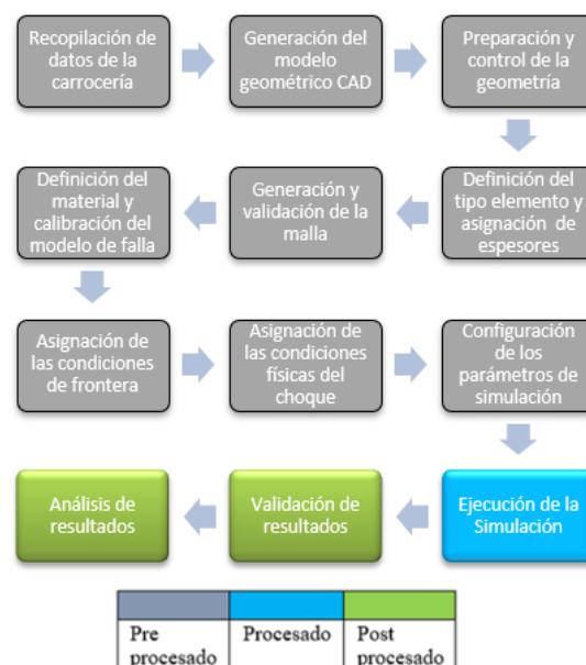
Figura 4. Diagrama de flujo de los pasos para crear una simulación con MEF
