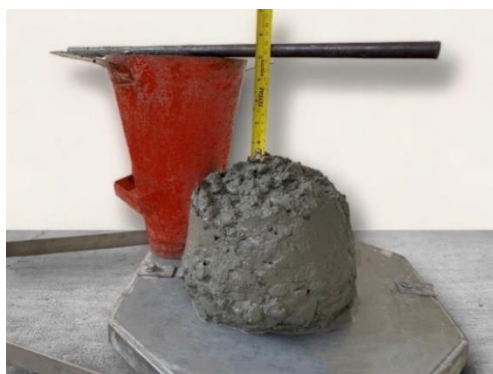
Figura 1. Ensayo de Cono de Abrams para medir la consistencia del hormigón.
