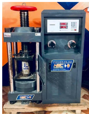
Figura 4. Evaluación de la resistencia a compresión del hormigón a través del empleo de la prensa de hormigón.
