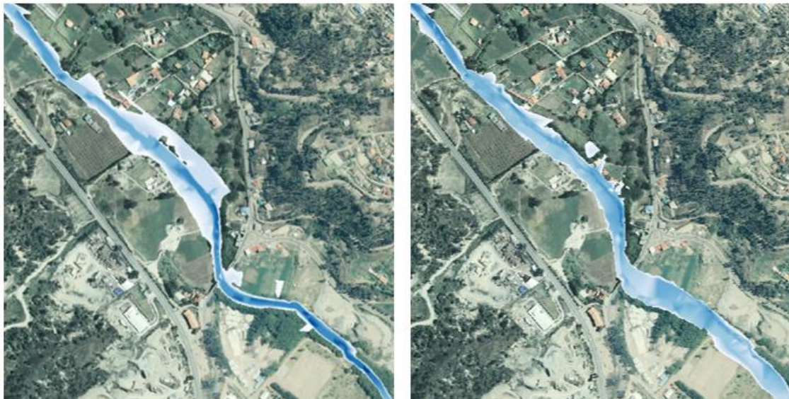
Figura 18. A la izquierda mancha de inundación con el escenario uno y en la parte derecha mancha de inundación con el escenario dos, para 100 años de retorno
