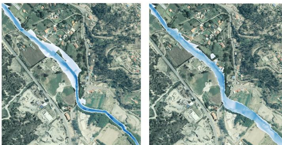
Figura 17. A la izquierda mancha de inundación con el escenario uno y en la parte derecha mancha de inundación con el escenario dos, para 50 años de retorno
