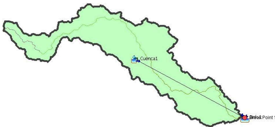
Figura 6. Quebrada Cunduana, Riobamba - Chimborazo delimitada en HEC-HMS
