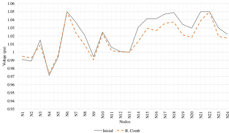
Figura 7. Comparativo de perfil de nivel voltaje en demanda máxima.
