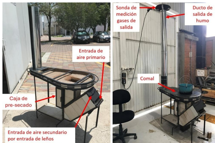
Figura 1. Prototipo de estufa rocket. a) Prototipo sin comal, b) Prototipo con comal
