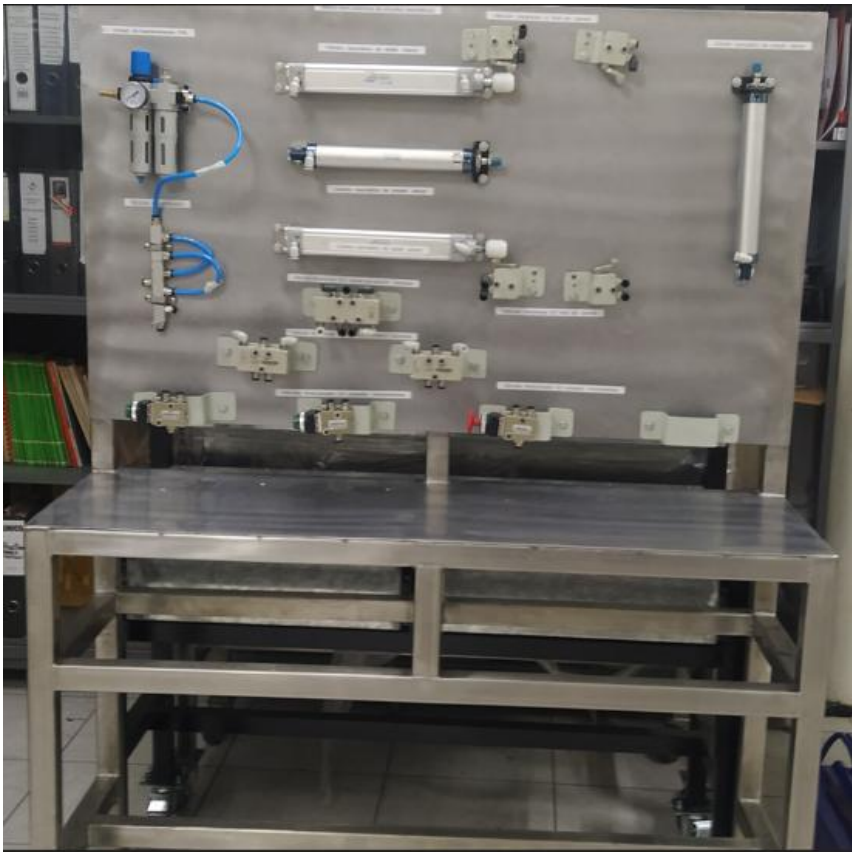
Figura 4: Banco didáctico para prácticas de neumática de la carrera de Tecnología en Mecánica industrial
