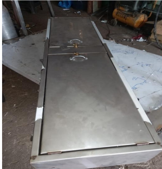
Figura 2. Caja de acero inoxidable terminada
