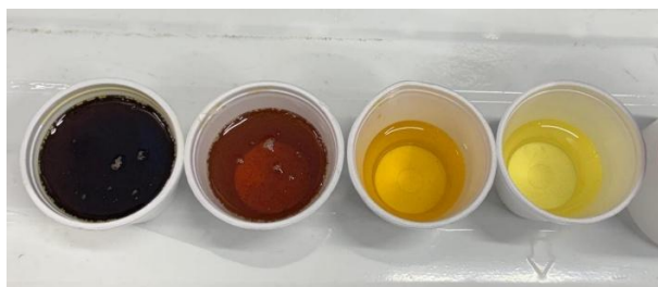
Figura 5. Evaluación visual del grado de degradación del aceite lubricante en un sistema Split tras la recuperación de R22
