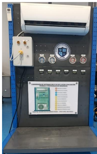
Figura 2. Módulo experimental para evaluación técnica en la conversión de R22 a R290 en sistemas Split
