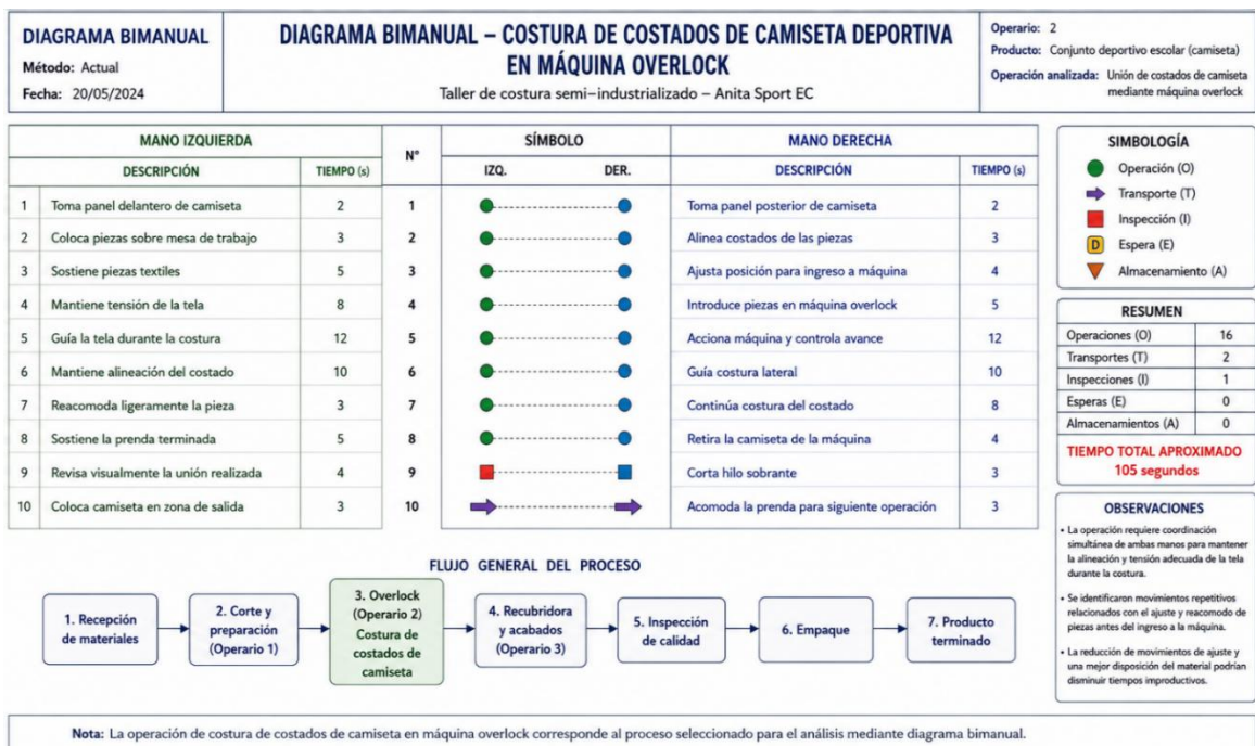
Figura 1 Mapa bimanual de la operación de costura de costados de camiseta en máquina overlock
