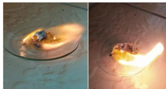
**Figura 6.** Prueba de combustión del biodiesel (muestra 60 min, 50 °C).
