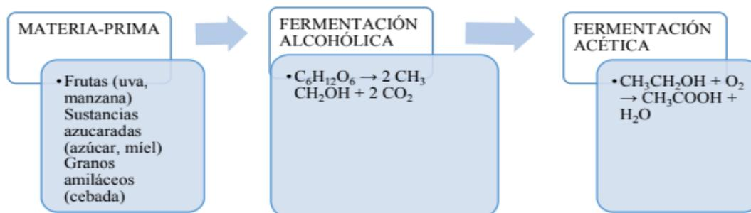
**Figura 1.** Esquema para la obtención de ácido acético.
